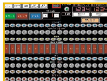
製本開始時や終了時のわずらわしい手順を自動で行い、最初と最後も1冊の本になります。落丁や乱丁（オプション）を認識すると、発生した箇所に応じる下流の折丁をストップし、余分なばらし作業を減らします。更に、認識した落丁は排出出力します。
