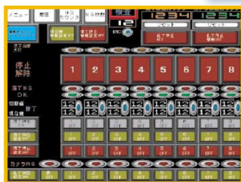
落丁認識を早くするため、駒ごとにセンサーを取り付けています。連続落丁の場合機械停止しますので、余分なばらし作業が減ります。更に、認識した落丁は排出出力もします。
