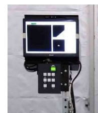
各鞍に配置した乱丁検査装置
